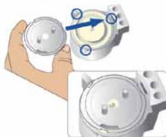
**5** Appuyer fermement sur le couvercle et **tourner vers la droite**.
