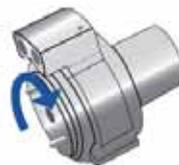
**6** Remonter l'ensemble sur l'Elisée, suivant les encoches (en faisant coïncider les 3 têtes de prise de pression).
