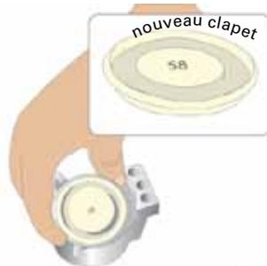
**4** **Positionner le couvercle** de façon à faire coïncider les encoches du couvercle avec les ergots de la base (1 grande + 2 petites encoches).
