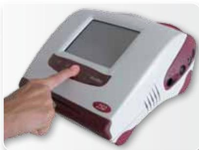
*Remarque : la première option vous permet de verrouiller la dalle tactile, ce qui peut être utile notamment lors de transports. Pour la déverrouiller il suffira d'appuyer sur le bouton Marche/Arrêt, sachant que toute alarme la désactive automatiquement.*
