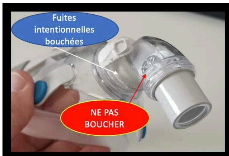
Figure 4 : exemple de bouchage de fuites, mais pas des orifices de la valve anti-axphyxie
